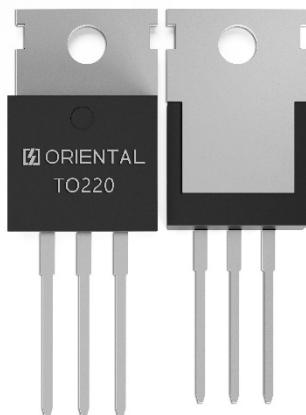
**2、散热性能：**封装内的金属片与器件内部结构紧密接触，能有效将热量传导到外部环境，安装时可将金属片与散热器连接，进一步提高散热效果。
