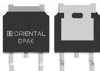
3、其中漏极 (D) 的引脚被剪断不用，而是使用背面的散热板作漏极 (D)，直接焊接在 PCB 上，一方面用于输出大电流，一方面通过 PCB 散热；所以 PCB 的 D-PAK 焊盘有三处，漏极 (D) 焊盘较大。其封装规范如下：
